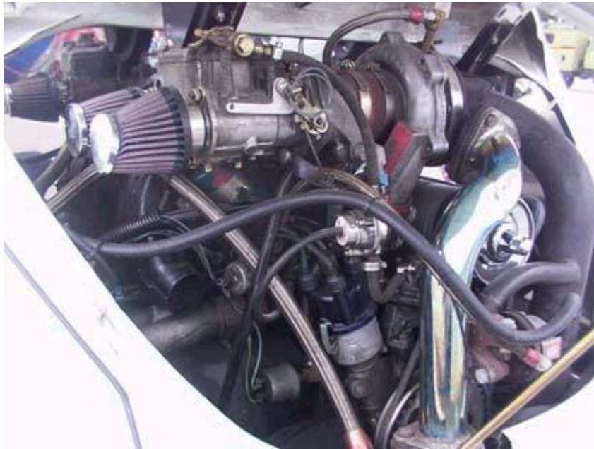
Unter der Haube: Side drafted pull through Turboladersystem
